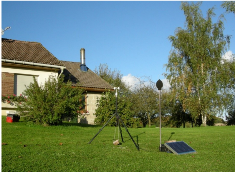
Figure 11 : Photographie d'un sonomètre en cours d'utilisation
